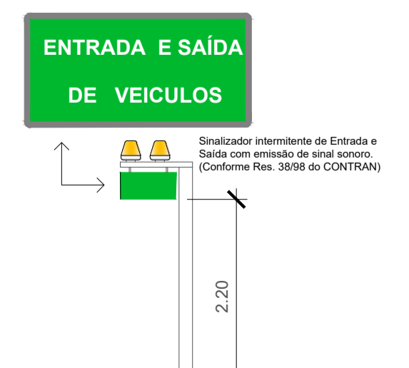
DETALHE DE ENTRADA E SAÍDA DE VEÍCULOS S/ESC
